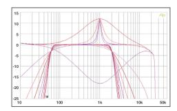
Der ESX beherrscht Flankensteilheiten bis 48 dB/Okt., mit dem Plus-EQ bis 12 dB sollte man vorsichtig sein. Nach oben wird bei 22 kHz abgeriegelt, vorher verliert der X-DSP schon 3 dB von 6 bis 20 kHz.
