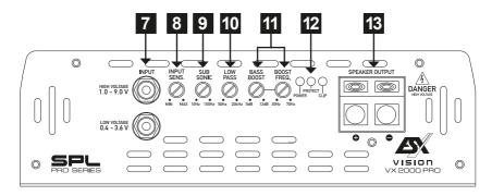
Am LINE INPUT befinden sich zwei Cinch-Eingänge, die jeweils mono angesteuert werden. Der Eingang LOW VOLTAGE ist für Niederpegelsignale von 0,4 bis 3,6 Volt geeignet. Am Eingang HIGH VOLTAGE können Sie ein Hochpegelsignal von 1,0 bis 9,0 Volt anschließen, wie es beispielsweise ein DSP liefert.
