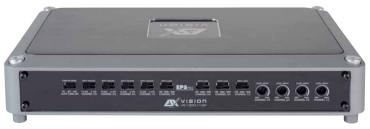
Bis auf die Stromklemmen läuft alles über Molex Steckverbindungen. Hinter einer Blende finden sich die Gainregler und Schalter des EPS Pro
