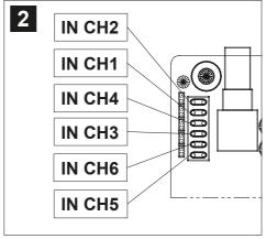
Entfernen Sie dann vorsichtig die Steckbrücke am gewünschten Eingangskanal, um diesen auf eine Eingangsempfindlichkeit von 2 ~ 15 V einzustellen. Verwenden Sie dazu eine geeignete Zange.
