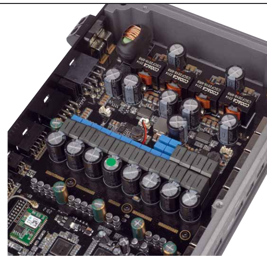
Die 4 Spulen oben gehören zum Step-up Netzteil
