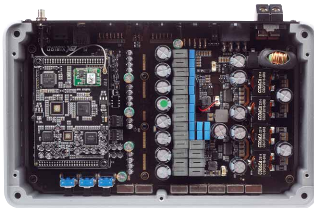
Die 7 Verstärkerkanäle sitzen in der Mitte der sehr wertigen mehrlagigen Platine, darunter befinden sich die Verstärker ICs
