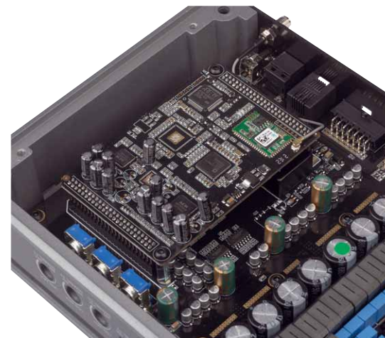
Die Digitalplatine beherbergt DSP und Bluetooth
