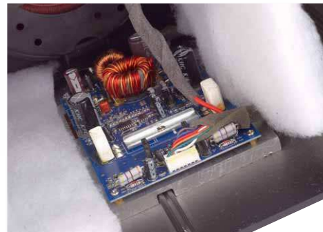
Die kräftige Analogendstufe ist zur Kühlung auf einer dicken Aluplatte montiert
