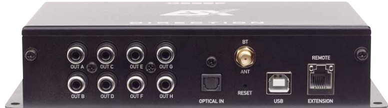
D68SP mit 8 Ausgängen, S/PDIF und Bluetooth-Antennenausgang. Der Fernbedienungsanschluss rechts ist eine richtige Schnittstelle für zukünftige Erweiterungen
