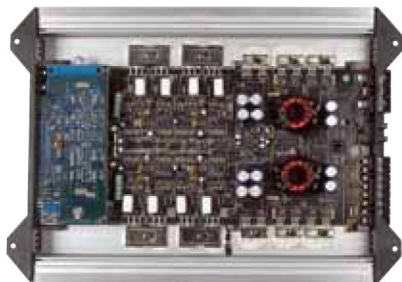
Ein Doppelnetzteil versorgt die vier Kanäle mit Spannung – besonders wenn Subwoofer im Spiel sind, ist das sinnvoll
