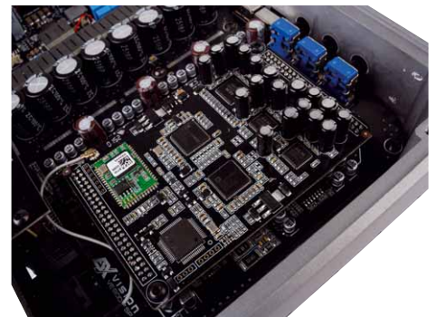
Der DSP mit zwei ADAU1452 sitzt zusammen mit dem Bluetoothchip auf einer Extraplatine
