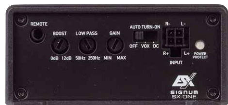
Die Mono hat einen Bassboost und Tiefpassfilter
