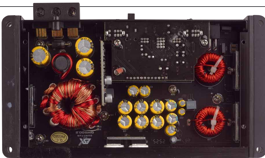
Nur die großen Bauteile wie Filter, Netztrafo und Pufferelkos sind zu sehen, die SMD-Bestückung sitzt auf der Rückseite
