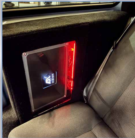
Jedes Seitenteil hinten beherbergt einen Verstärker
