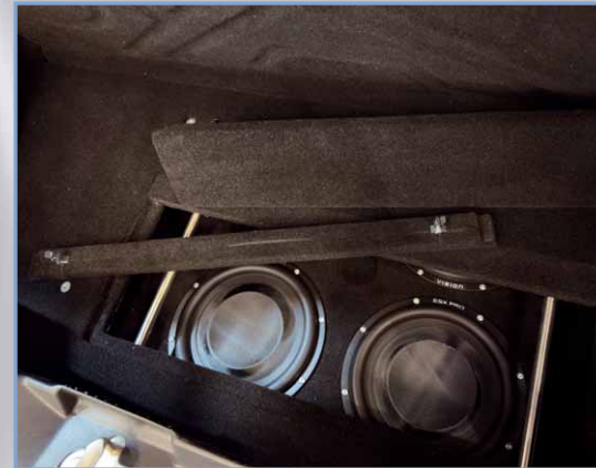
Beim CDS Subwoofer sorgt eine Platte vor den Membranen für eine gezielte Veränderung der Parametrie
