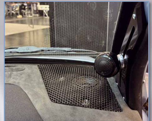
Schwenkbar gelagerte und in einer Schiene bewegliche Hochtöner
